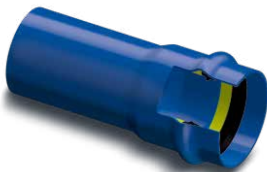
Visione assonometrica tubo in PVC-A con guarnizione FORSHEDA POWER-LOCK preinserita meccanicamente a caldo durante la fase di bicchieratura del tubo
